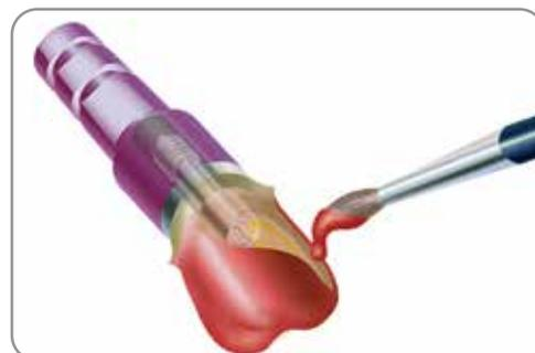
Crie o contorno final da coifa com cera de coroa e ponte. Fixe um sprue de cera de calibre 10 na parte mais espessa da coifa. Revestir a coifa:
