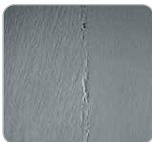
Fig. 3 A MEV com ampliação de 150x apresenta a interligação mecânica na área de conexão hexagonal entre as superfícies planas do implante e do pilar.
