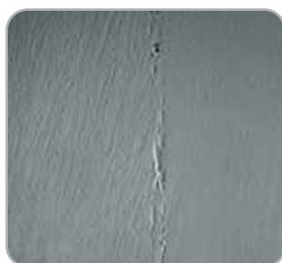
Fig. 3 SEM con ingrandimento 150X mostra l'interblocco meccanico nella superficie di aggancio esagonale tra i piani dell'impianto e l'abutment.
