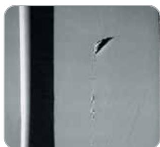
Fig. 2 SEM con ingrandimento 50X mostra un contatto profondo dell'impianto interno esagonale sia sull'interfaccia bisellata impianto/abutment sia sulla superficie di aggancio esagonale.
