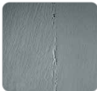
Fig. 3 La imagen de microscopía electrónica (SEM) a 150 aumentos muestra el bloqueo mecánico en la zona de encaje hexagonal entre las caras planas del implante y del pilar.
