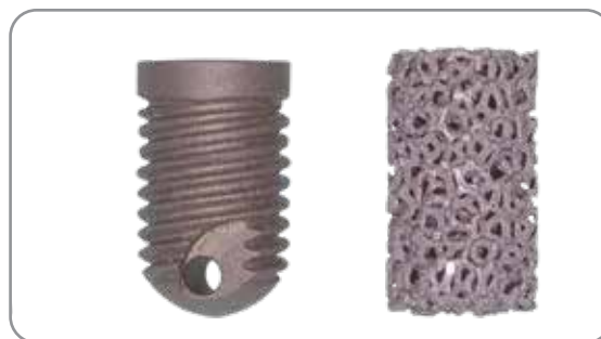
Cylindres d'implants Ti et TM filetés utilisés dans l'étude.
